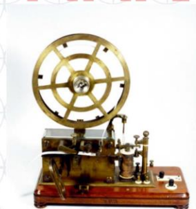
オランダから開陽丸で持ち帰った通信機。 《ディニエ製モールス印字通信機》
